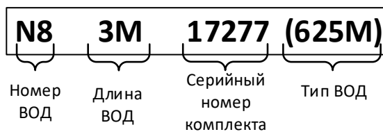
Рис. 1.14 – Формат маркировки датчика ВОД
