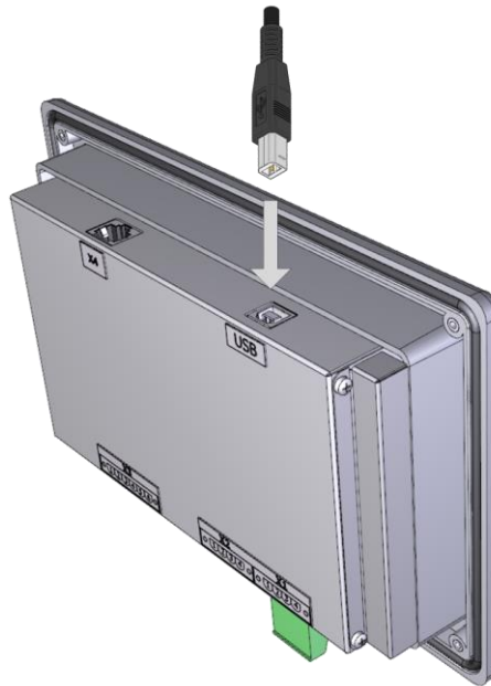
Рисунок 1.61 – Подключение кабеля к разъему USB
