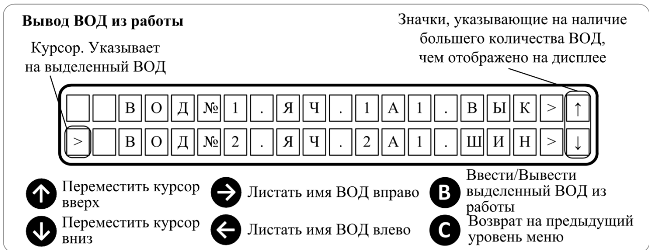
Рисунок 1.45 – Ввод/Вывод датчиков из работы
