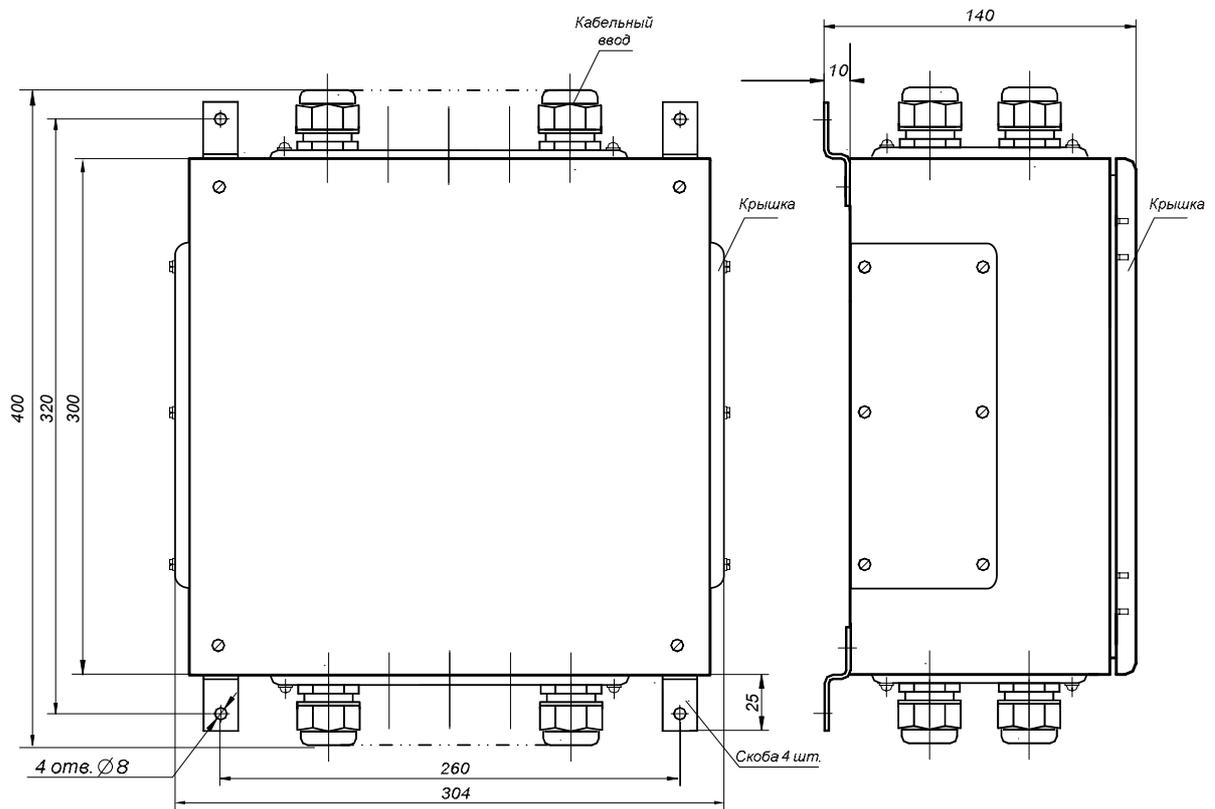
Рис. 1.5. Габаритные размеры клеммного шкафа.
