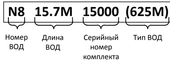
Рисунок 1.14 – Формат маркировки датчика ВОД
