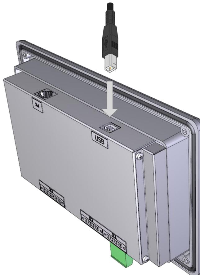
Рисунок 2.34 – Подключение кабеля к разъему USB
