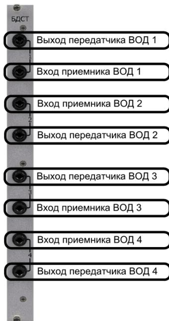
БДСТ с 4 каналами для подключения ВОД
