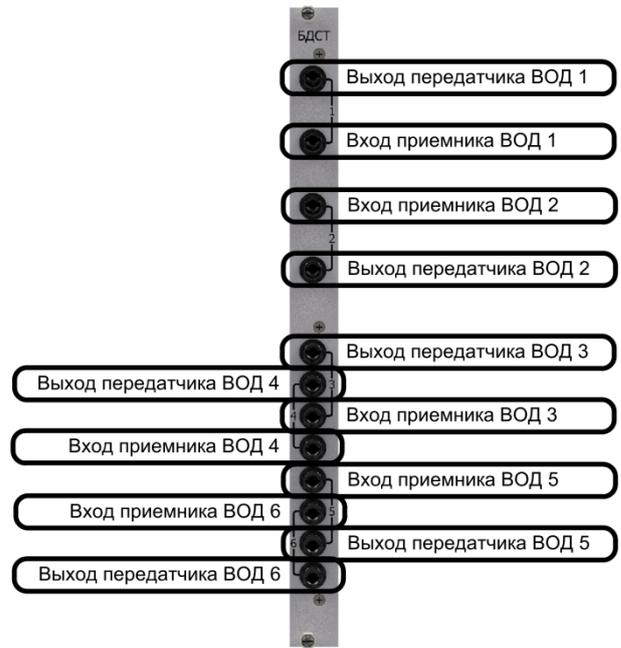
БДСТ с 6 каналами для подключения ВОД
