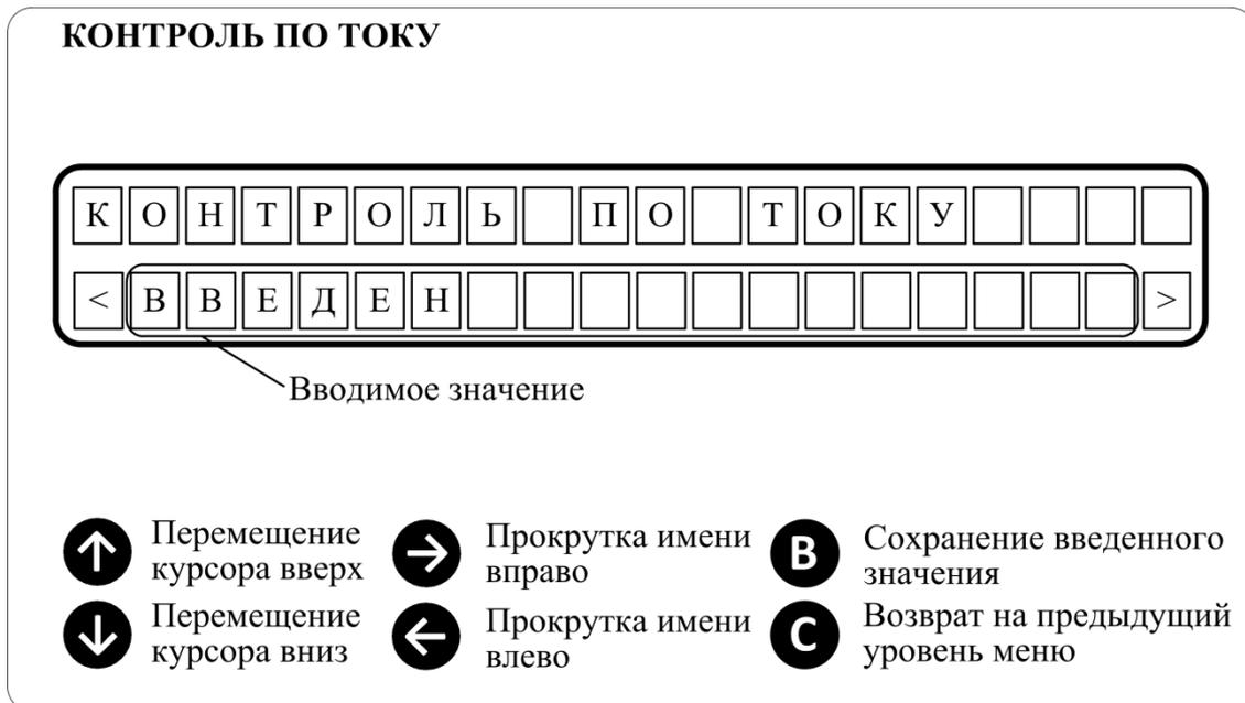
Рисунок 2.17 – Установка состояния контроля по току
