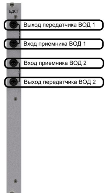
БДСТ с 2 каналами для подключения ВОД
