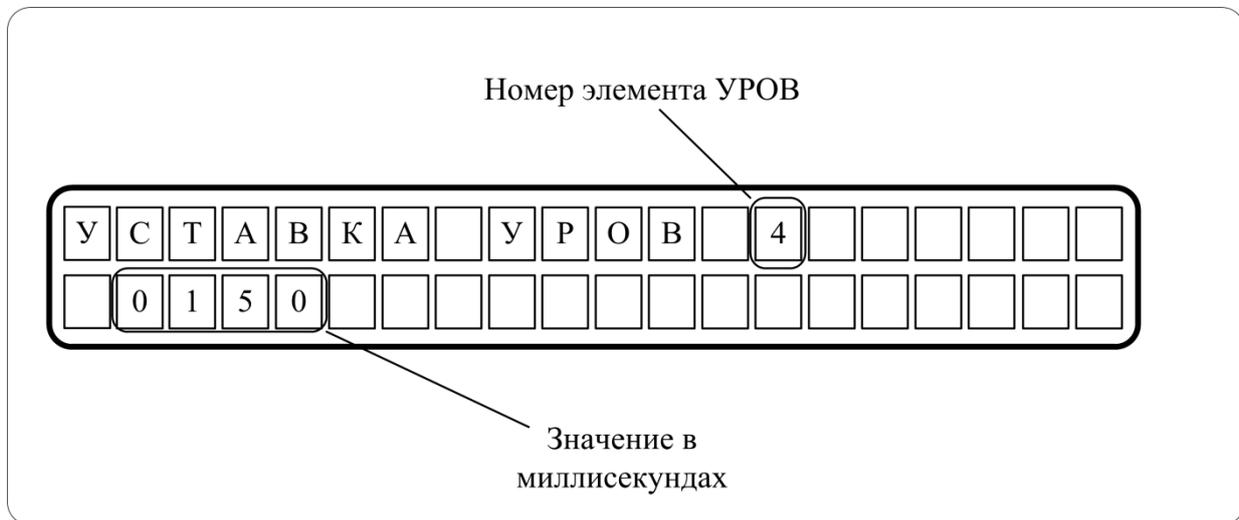
Рисунок 2.39 – отображение установленного порога элемента УРОВ №4
