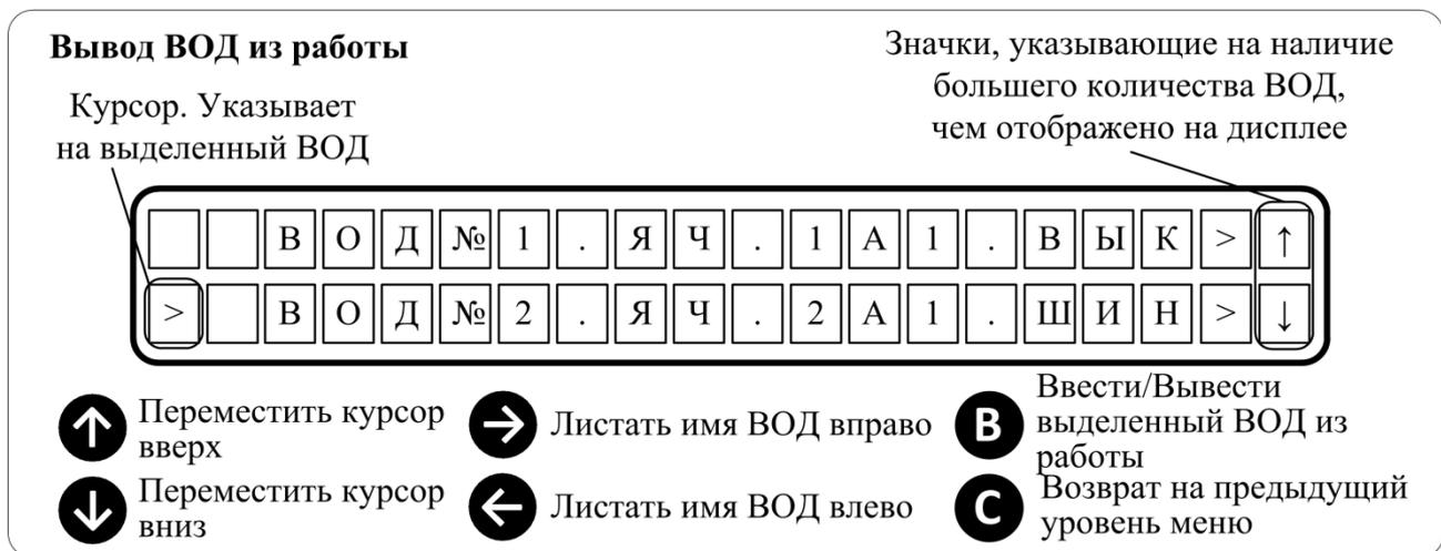
Рисунок 2.18 – Ввод/Вывод датчиков из работы
