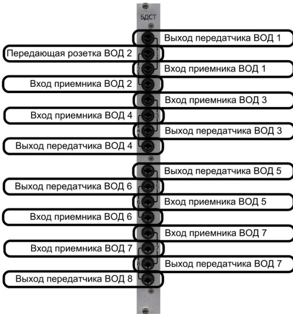
БДСТ с 8 каналами для подключения ВОД
