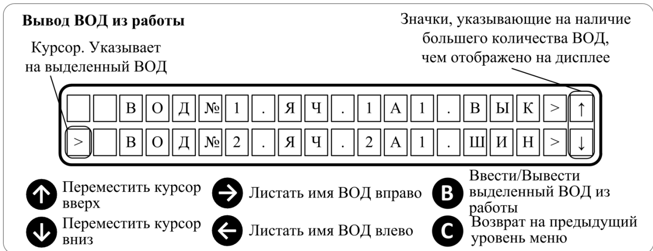
Рисунок 2.18 – Ввод/Вывод датчиков из работы
