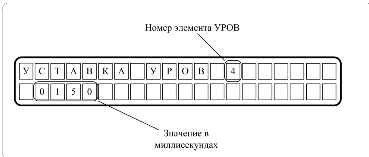
Рисунок 2.39 – отображение установленного порога элемента УРОВ №4
