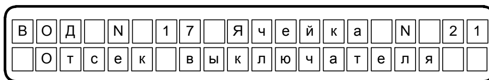
Рис. 1.30. Просмотр названия элемента устройства, инициировавшего неисправность.
