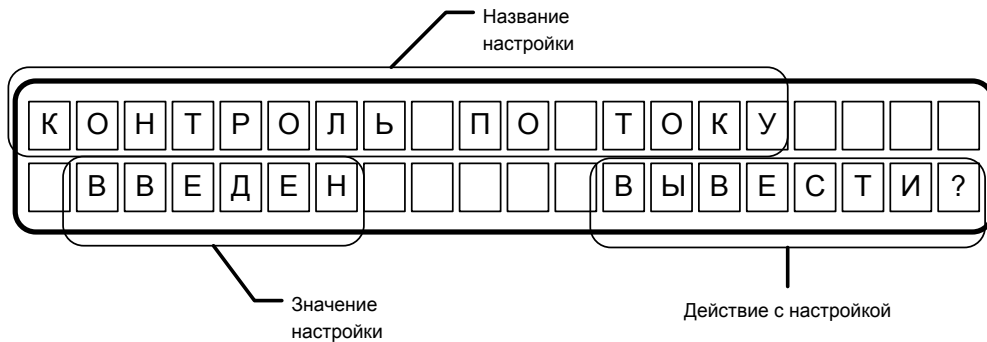
Рис. 1.23. Диалог установки значения настройки «Контроль по току».
